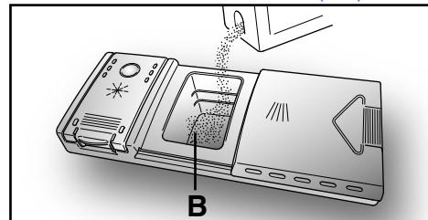
После загрузки моющего средства закройте контейнер, для чего слегка сдвиньте крышку (**1**), а затем слегка нажмите на нее (**2**) до щелчка.
